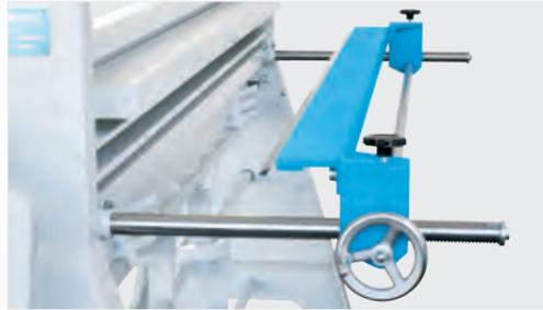
Der manuelle Tiefenanschlag mit Anschlagbalken ist bestens geeignet für kleinformige Werkstücke und Einzelanfertigungen. Die Einstellung der Biegelänge erfolgt per Hand durch Positionsrad und Maßskala.
