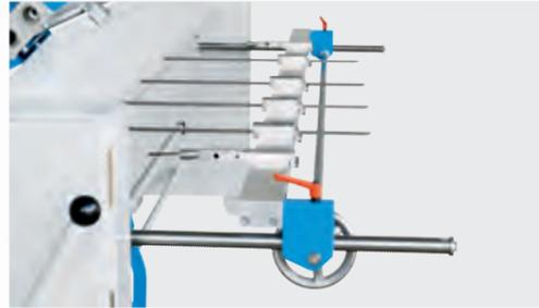
Der manuelle Tiefenanschlag ist mit drehbaren Anschlagfingern und dem Auflagerost für großformatige Werkstücke ausgestattet. Das bringt präzise Büge über die gesamte Arbeitslänge. Die Einstellung der Biegelänge erfolgt per Hand durch Positionsrad und Maßskala.
