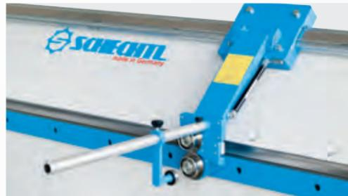
Einfache und platzsparende Rollenschere. Die Führungsstange gewährleistet einen präzisen Schnitt über die gesamte Arbeitslänge. Damit schneiden Sie Bleche direkt an der Schwenkbiegemaschine. Diese Variante spart im Einzelfall den Einsatz einer Tafelschere.
