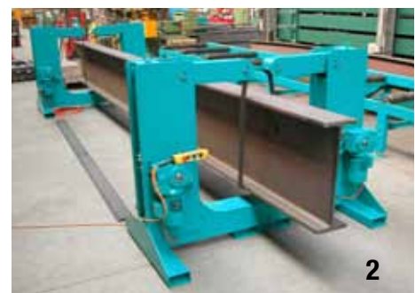
222 Arme schliessen automatisch Arms closes automatically
