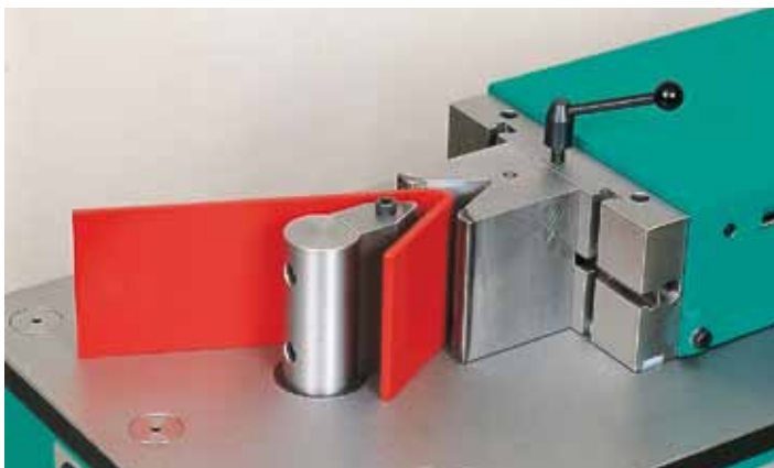
101 Prisma und Stempel 55° Vee-block and punch 55°
