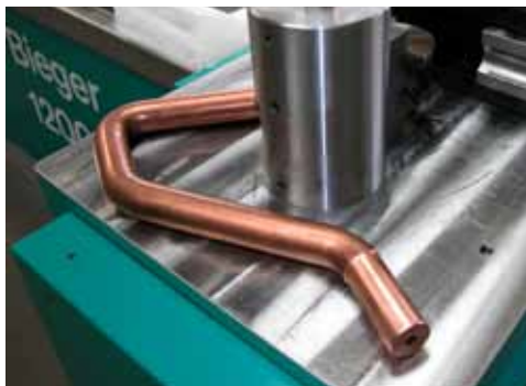
71 Kupferelektroden biegen Copper electrode bending
