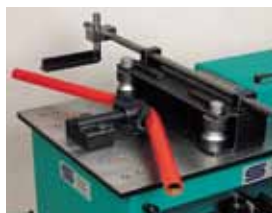
242 Rohre biegen Pipe bending
