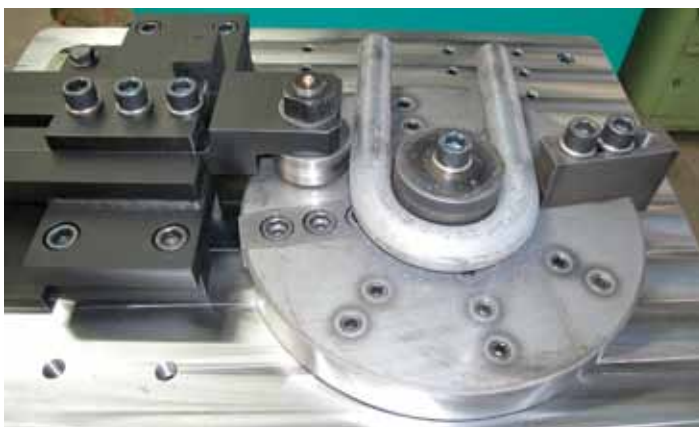
173 Standard Tischaufbau mit Gegenhalter, Mitnehmer und Biegebolzen Standard base with bending roll, driver and bending bolt
