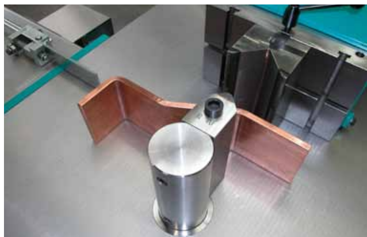
142 Biegen mit Standard Prisma und schneller Winkelprogrammierung Bending with standard vee-block and fast programming
