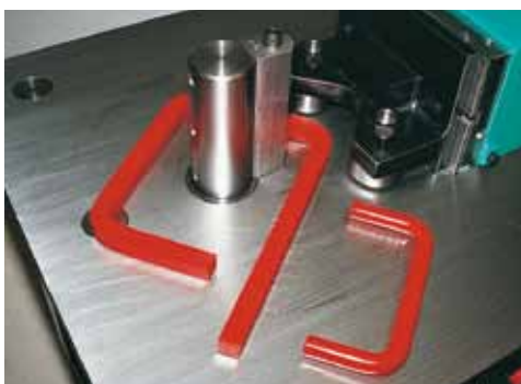
47 Rollenprisma für Rund- oder 4kt. Material Roller vee-block for round, square or rectangle
