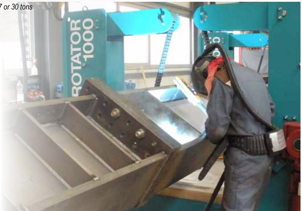
232 Schweißen und Verputzen in Wannenlage erhöht die Produktivität Welding and dressing in sag curve increases productivity
