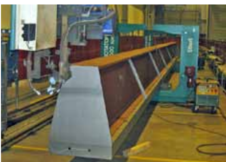
236 ROTATOR mit Schweißroboter kombiniert ROTATOR in Kombination with welding robot
