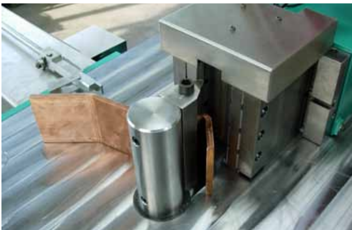
151 Prisma mit integriertem Messsystem für automatisches Nachbiegen Vee-block with integrated measuring system for automatic re-bend
