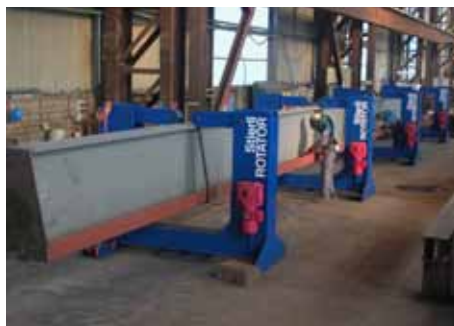
234 Mehrere Rotatoren für sehr lange Teile Several Rotators for very long parts
