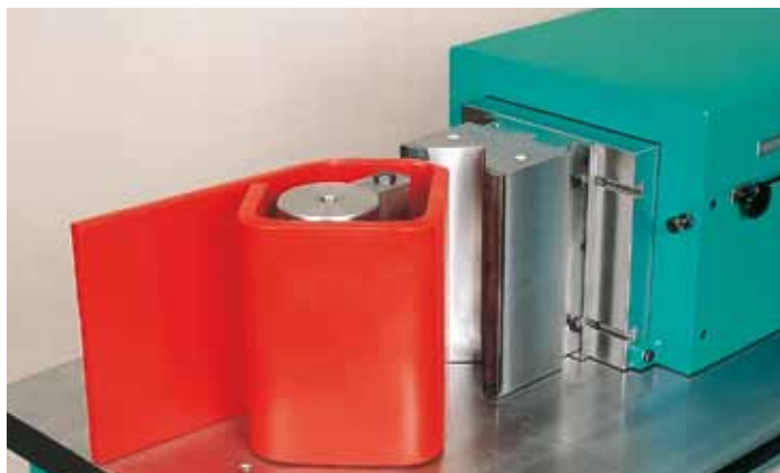
111 Biegen 300/30 Bending 12" x 1 1/4"
