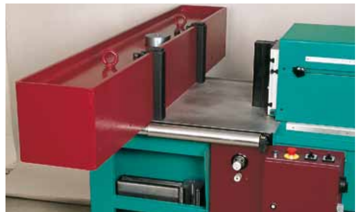
112 Richten bis HEA 260 Straightening up to HEA 260
