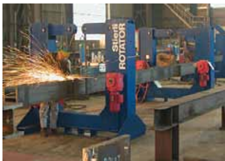
233 Einstellbare Arbeitshöhe + 2 Drehrichtungen Adjustable height and 2 turning directions
