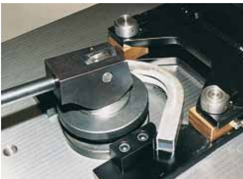
65 Biegen von 4-kt Röhren Bending of square pipes
